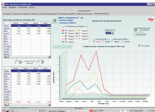
Система "АСКУЭ-быт" ведет картотеку счетчиков установленных у абонентов сети, или находящихся в нерабочем состоянии: ремонт, поверка, склад и так далее.
