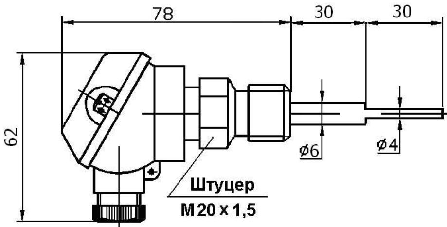
**Рисунок 15 Габаритные размеры датчиков температуры ТСП-Н.5.0.00.15.7.3.0 (тип 3)**
