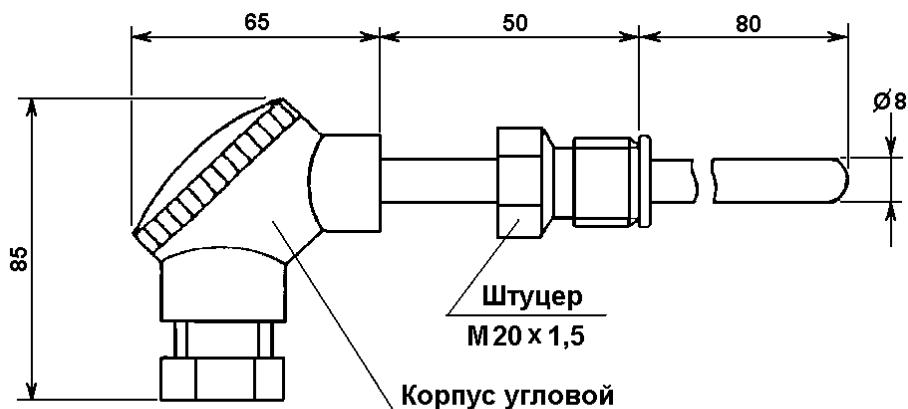
**Рисунок 13 Габаритные размеры датчиков температуры
