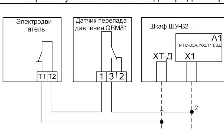
**Рисунок 8 Подключение защиты электродвигателя**
