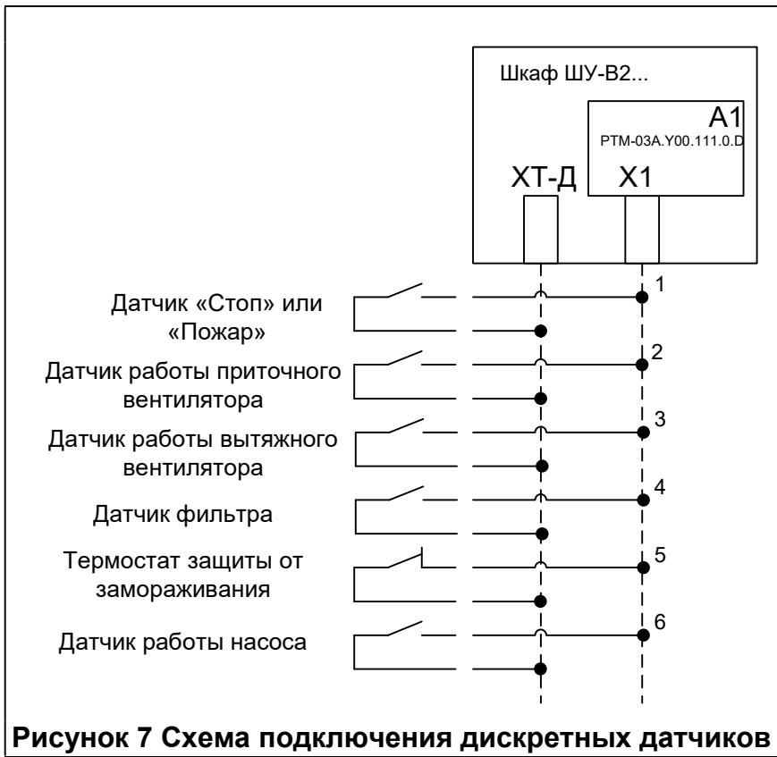
**Рисунок 7 Схема подключения дискретных датчиков**
