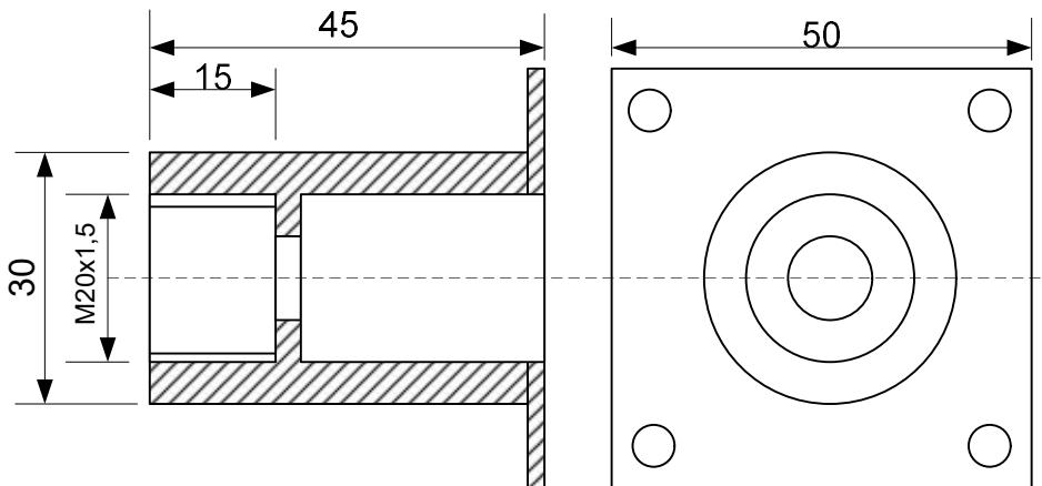
**Рисунок 18 Габаритные размеры бобышки ТНИВ 715341.011 для установки датчиков температуры ТСП-Н.5.0.04.02.7.1. (датчиков температуры типа 5)**
