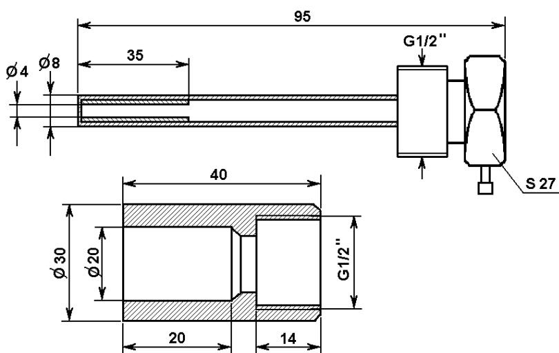
**Рисунок 16 Габаритные размеры гильзы ТНИВ 301116.010-01 и бобышки ТНИВ 715341.005-01 для установки датчиков температуры типа ТСП-Н. 5.0.01.00.7.3.0 (датчики температуры типа 2)**
