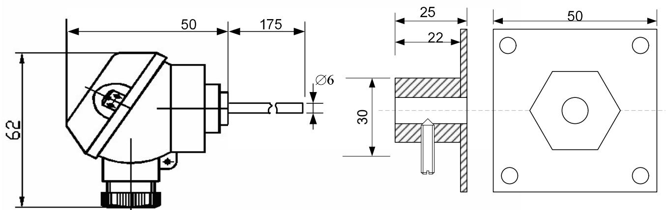
**Рисунок 20 Габаритные размеры датчиков температуры ТСП-Н.5.1.04.00.7.1.1 (тип 6) и бобышки ТНИВ.715341.013**
