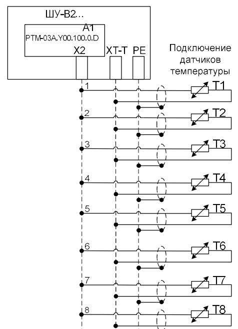
**Рисунок 12 Подключение датчиков температуры к РТ**
