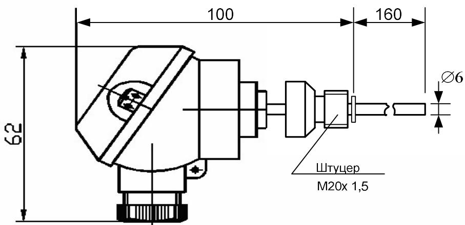
**Рисунок 17 Габаритные размеры датчиков температуры ТСП-Н.5.0.04.02.7.1.1 (тип 5)**
