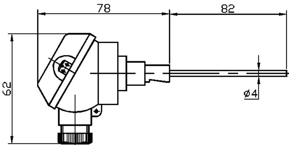
**Рисунок 14 Габаритные размеры датчиков температуры
