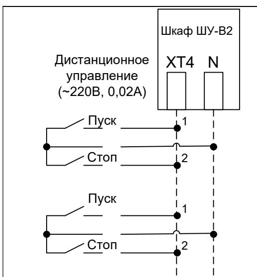
К шкафу управления возможно подключение внешнего пульта управления с кнопками «Пуск» и «Стоп». Схема подключения показана на рисунке 4. Внешних пультов управления может быть подключено несколько в разных помещениях. В качестве пультов управления возможно использование пультов дистанционного управления описанных в разделе 7.
