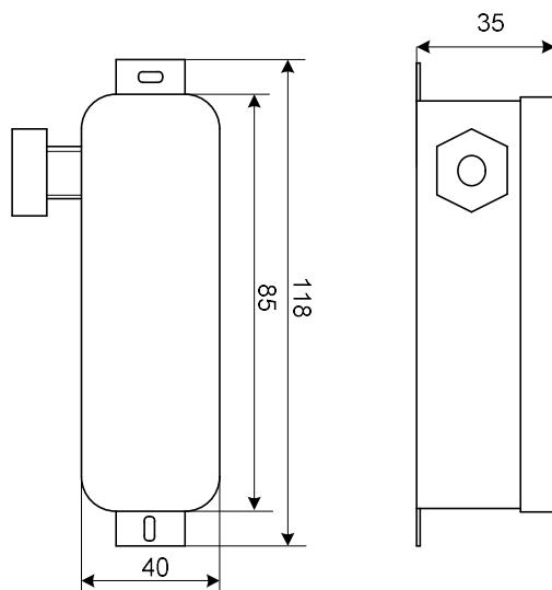
**Рисунок 19 – Габаритные размеры термопреобразователя сопротивления типа ДТН 500**
